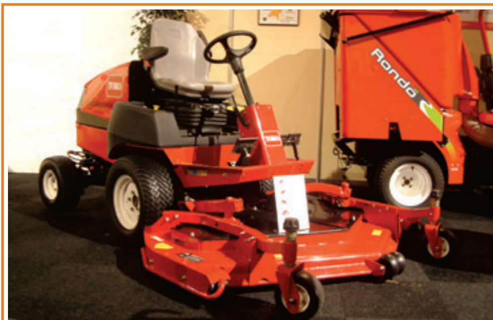
Jean Heybroek toonde een prototype van de Toro Groundsmaster 3280-D. Deze frontcirkelmaaier volgt de 228 en 328 serie op. De basis is ook gelijk. De maaier is wendbaar en compact. Hij heeft een 20,6 kW (28 pk) Kubota dieselmotor. Nieuw is een 180 cm breed maaidek, naast de 132 en 157 cm, dat een mooi maaibeeld en brede spreiding moet geven door zijn lage bouw. De onderdelen zijn dezelfde als andere Toro maaiers. Prijs is ongeveer 22.000 euro, optie is een cabine.
