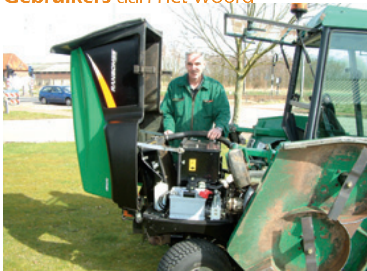
De radiator en de oliakoeler kunnen schoongemaakt worden door de radiator naar achter weg te klappen. Jack Verhoeven van Krinkels B.V. haalt het fijnfilter vanachter de oliekoeler vandaan zodat dit ook kan worden schoongemaakt.
