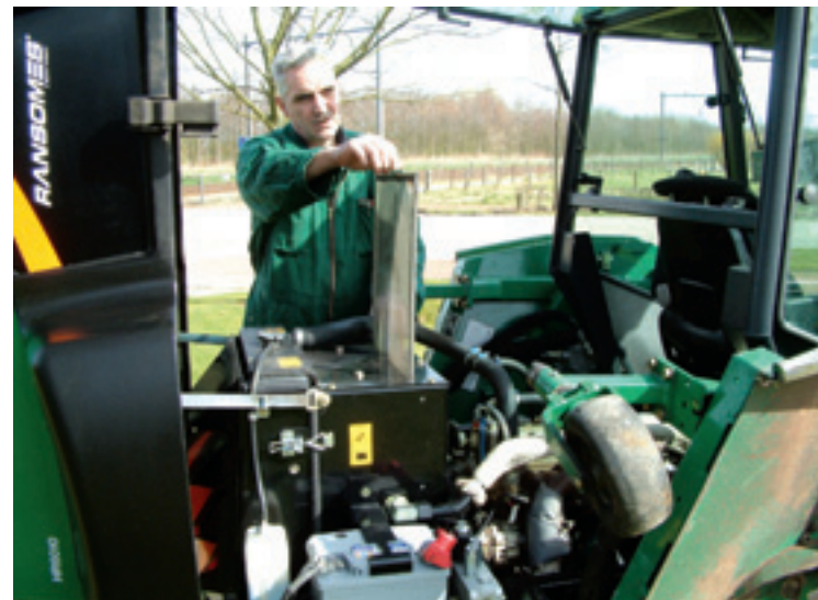
De radiator en de oliakoeler kunnen schoongemaakt worden door de radiator naar achter weg te klappen. Jack Verhoeven van Krinkels B.V. haalt het fijnfilter vanachter de oliekoeler vandaan zodat dit ook kan worden schoongemaakt.
