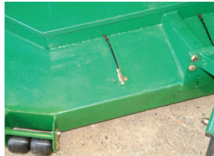
Om eenvoudig de lagers onder de machine te smeren, heeft Jack Verhoeven de smeernippels op een maaidek geplaatst.
