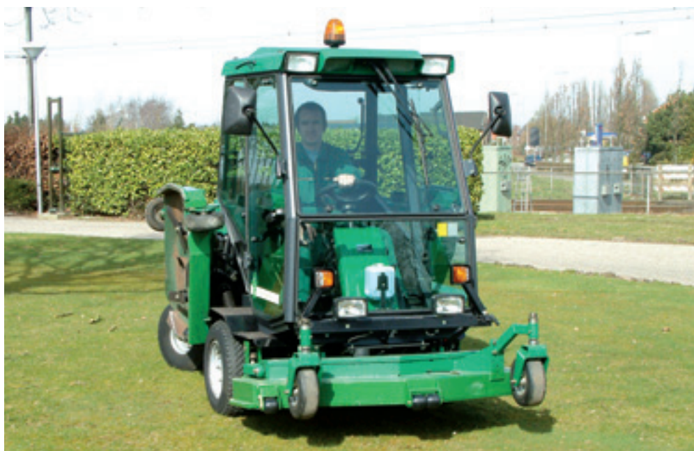
Peter de Bont van Krinkels heeft beide zijdekken opgeklapt en kan nu kleine grasvelden maaien en door smalle doorgangen rijden.
