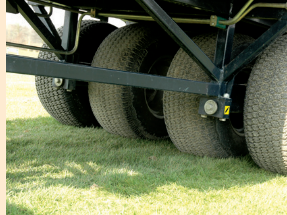
Zand is zwaar en insporing is funest. Verschillende fabrikanten passen daarom banden toe over de volle breedte van de machine. Zeker voor een borstelstrooier geeft dat een egale 'bewerking' van het veld. Hoewel voor een lage bodemdruk twee grote soepele banden niet onder hoeven te doen voor vier kleine banden naast elkaar.
