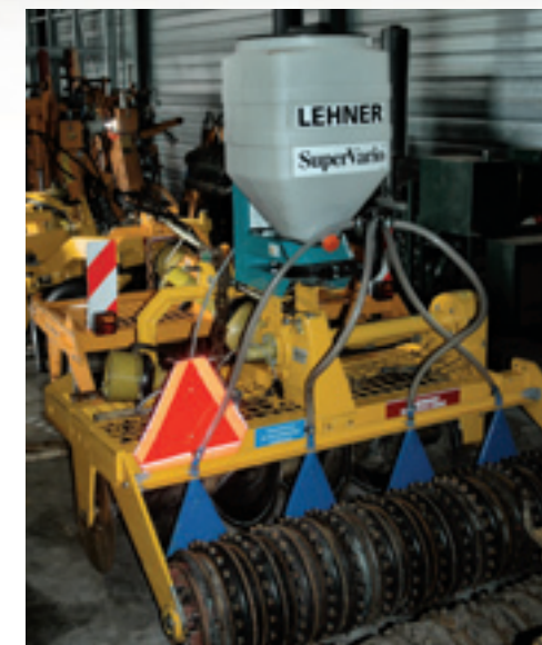
Er zijn eenvoudige, elektrisch aangedreven pneumatische zaaisystemen te koop. Die zijn gemakkelijk op een machine te bouwen en de gewenste werkbreedte is binnen zekere grenzen aan te passen.
