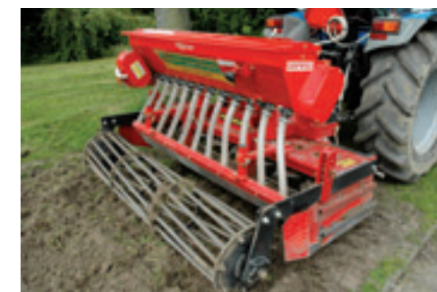
Een nokkenrad of in dit geval een schuifradsysteem kan heel nauwkeurig kleine hoeveelheden doseren. Het principe is gebaseerd op een rijenzaaisysteem, daarom wordt vaak een ketsplaat gemonteerd om breedwerpig te zaaien.
