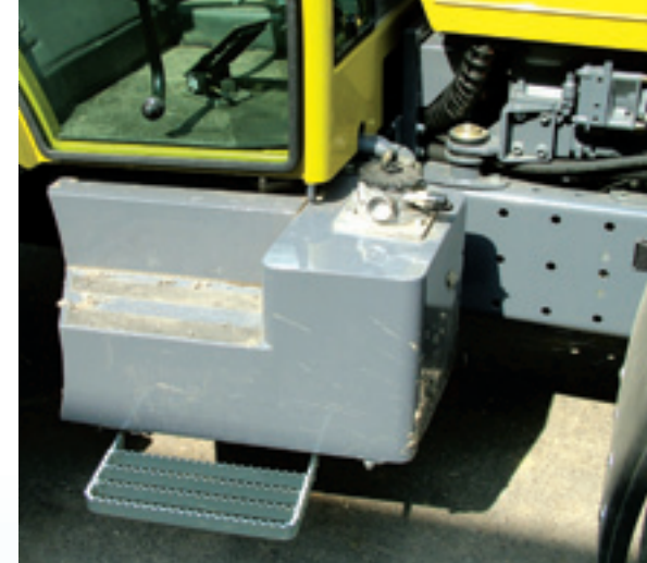
De olie en dieseltank zitten mooi weg-gewerkt onder de cabine.
