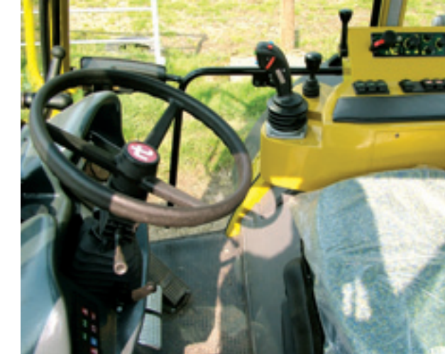
Met de joystick op de zijconsole kun je zowel de belangrijkste hydraulische functies bedienen als de rijrichting bepalen.
