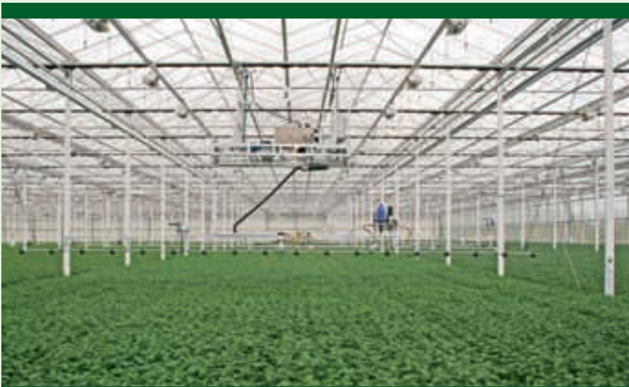
Door het gebruik van een spuitrobot hoeft niemand meer in de kas te zijn tijdens het spuiten.
