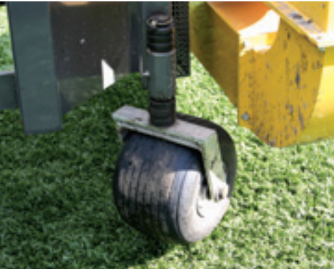
De hoogte van de wielen stel je in door de stelringen te verplaatsen.
