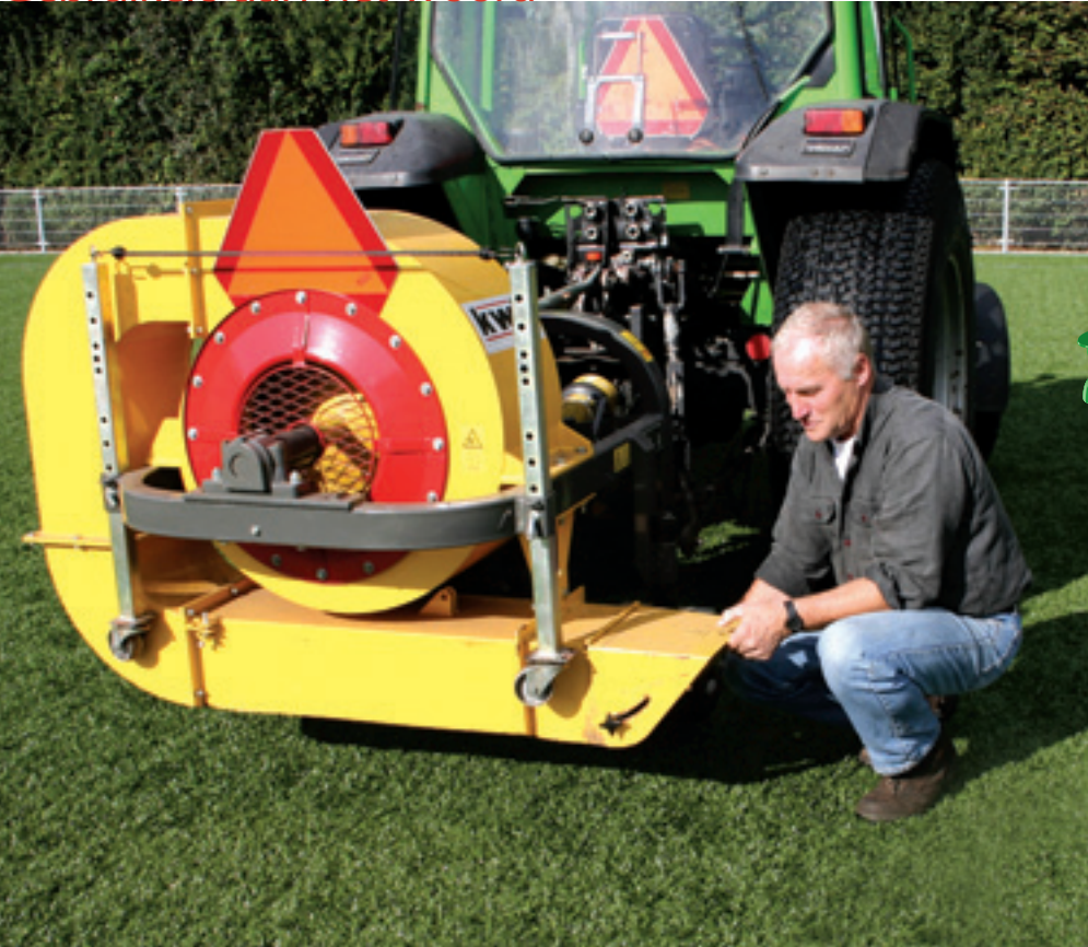
Henk de Bruin van Buitensport in Veenendaal stelt de blaasmond van de blazer af. Staat deze teveel in het gras gericht, dan wordt het rubber van tussen de grassprietten geblazen.
