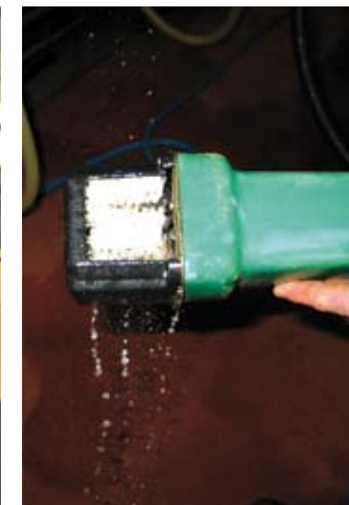
Het desinfectiemiddel sijpelt tussen de borstels door.
