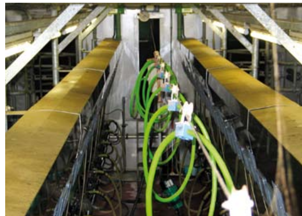
Puli-Sistem bestaat uit één handzaam apparaat aan een staalkabel. Daardoor kun je het apparaat over de hele lengte van de melkstal heen-en-weer bewegen.
