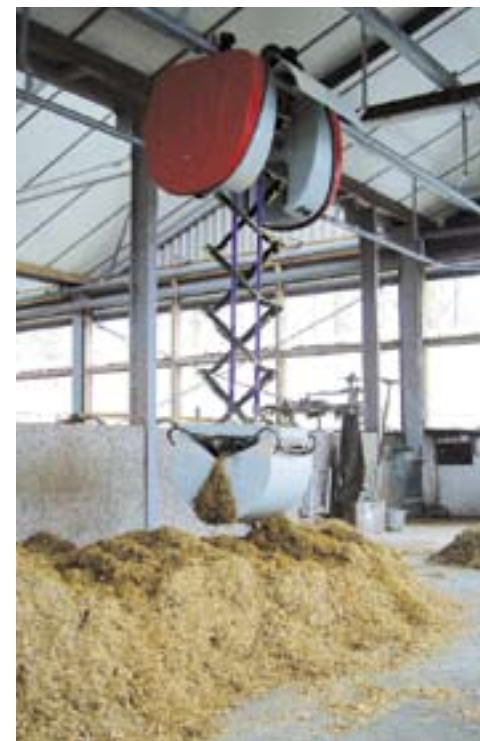
De trolley, een grote grijper met een inhoud van 60 liter, haalt het gehakselde voer aan het eind van de stal op.
