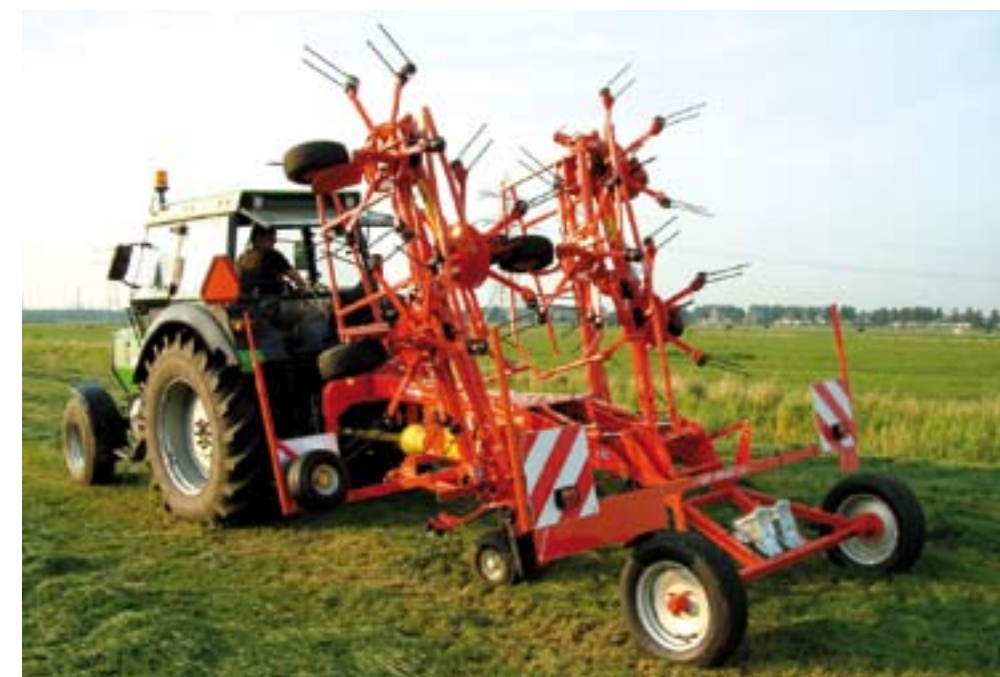
Op het land hef je het transportwielstel hydraulisch, waarna de rotoren omlaag kunnen.
