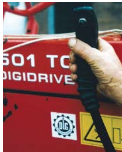
Met een joystick is de schudder schuin te stellen. Handig, want daardoor hoeft de trekker maar een dubbelwerkend hydraulisch ventiel te hebben. Helaas past de joystick niet over elke hydrauliekhendel, waardoor je nog steeds twee handen nodig hebt om de machine te verstellen.
