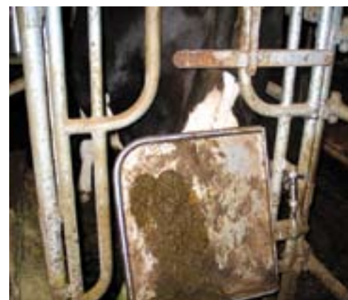
Een gepatenteerde mestgoot moet voorkomen dat de spreidplaat vervuilt.
