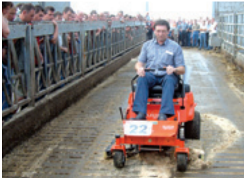
De zero-turn roosterschuij van Eliet draait via stick-besturing om zijn eigen as.
