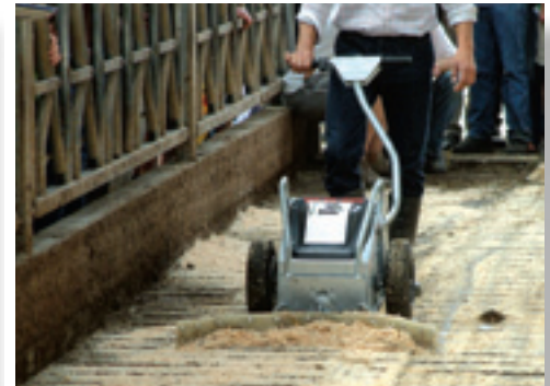
Er is geen herrie en het is lichter dan een vloerentrekker. De elektromotor in de Heitmann is er een van 5 pk.
