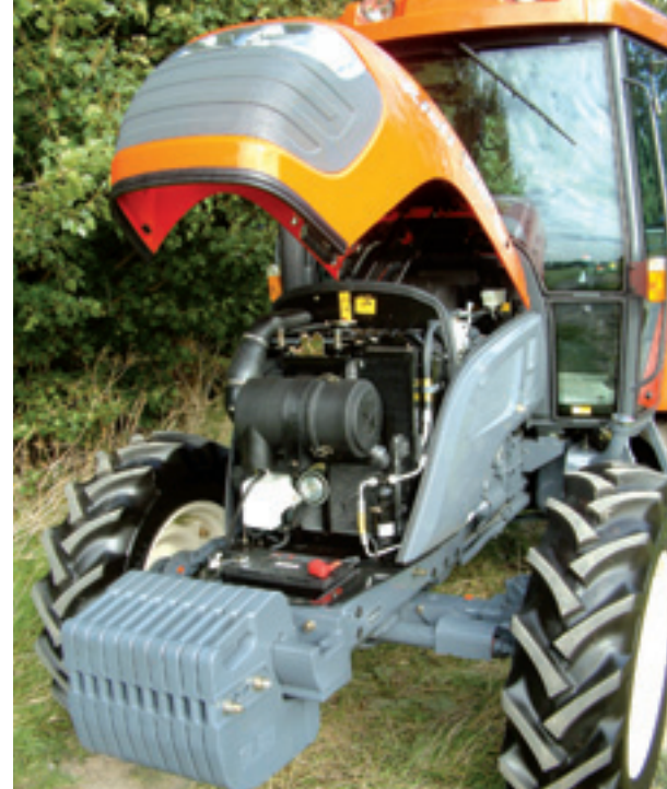
De kunststofmotorkap van de Kiota opent bij de cabine. Hij gaat naar Europese maatstaven niet echt ver open. Toch is de motor goed bereikbaar; zeker voor dagelijks onderhoud.
