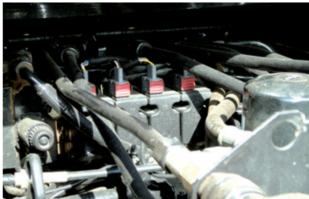
Voorop de rechter armleniging zit een joystick. Door de elektrische stekkers op de ventielen om te steken, kunt u zelf bepalen welke functies u met die joystick wilt aansturen.
