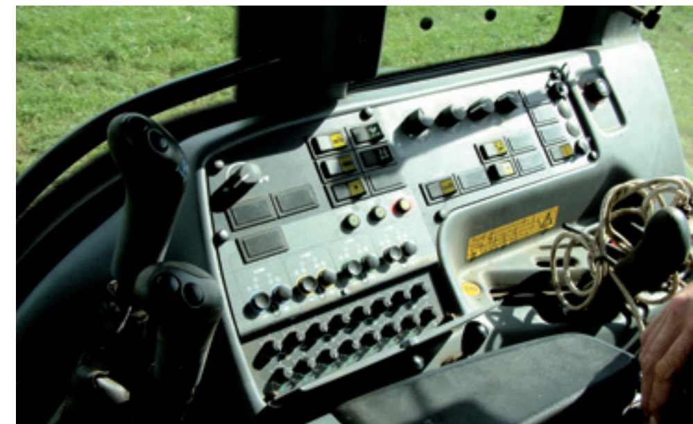
In de grote hoeveelheid bedieningsknoppen zit logica. Met de onderste rijen knoppen kunnen de functies van de bovenste rij worden ingesteld. Daarna gaat de klep dicht.
