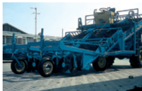
De voorkant van de vierrijige Barth-rooier heeft geen diabolorollen. Naast de motor op de achterkant van Barth-rooier is plaats voor iemand die de dwarsafvoer bedient (zie foto boven).
