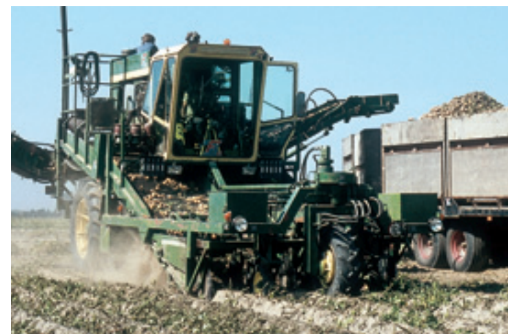
Het tweede model van de vierrijige aardappelrooier van De Feijter heeft aan de voorzijde maar een groot steunwiel.
