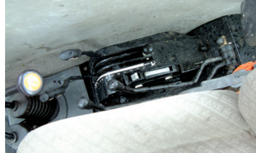
Net als bij andere trekkers in zijn klasse is de hefinrichting van de Case IH JX95 in te stellen op trekweerstand, een vaste positie en mengstand. De hendels, ook die voor de bediening van de hydraulische cilinders, zitten tussen stoel en spatbord in.
