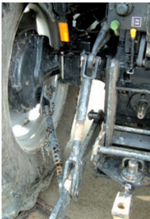
De hef van de JX95 tilt maximaal 3.656 kg. Om de aftakas om te schakelen van 750 naar 540 moet achter de cabine een hendel om gezet worden.
