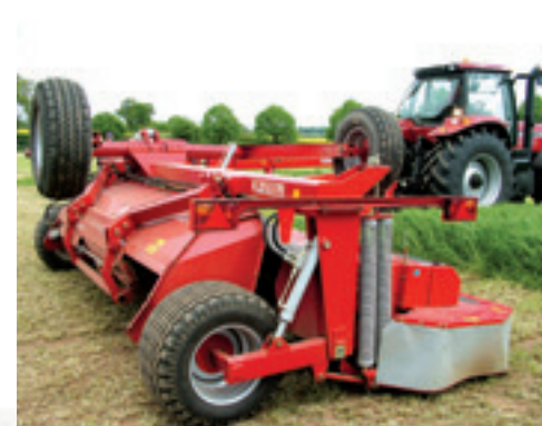
De GMS 4802 Dual Line van JF heeft een kneuzer met kunststofstanden.
