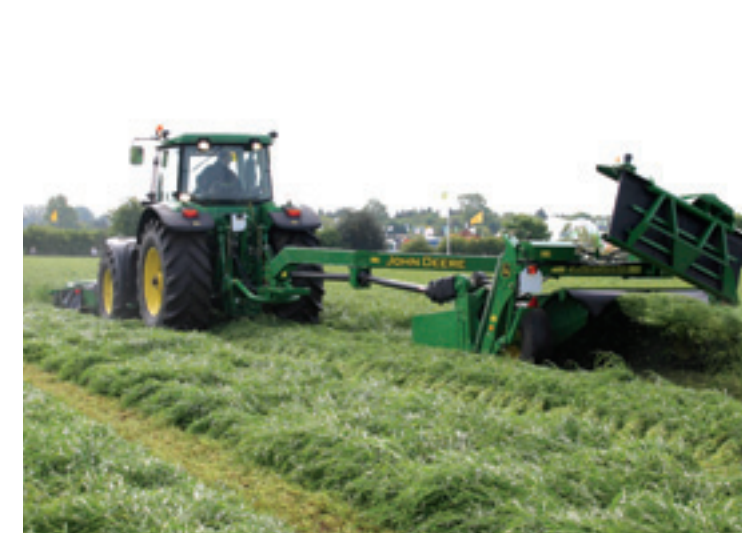
Een geknikte dissel, levert tijdens transport een stabiele maaier op, meent John Deere.
