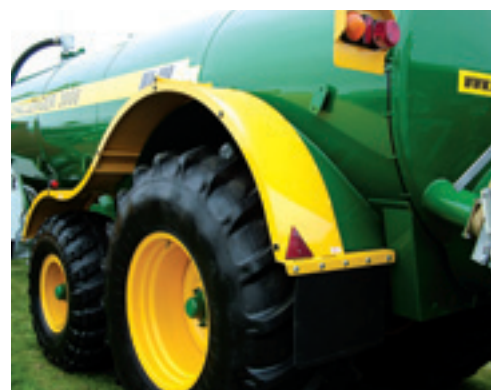
Op de weg is de gevulde Major tank veel te zwaar. Een extra as met kleinere banden moet dat probleem wegnemen.
