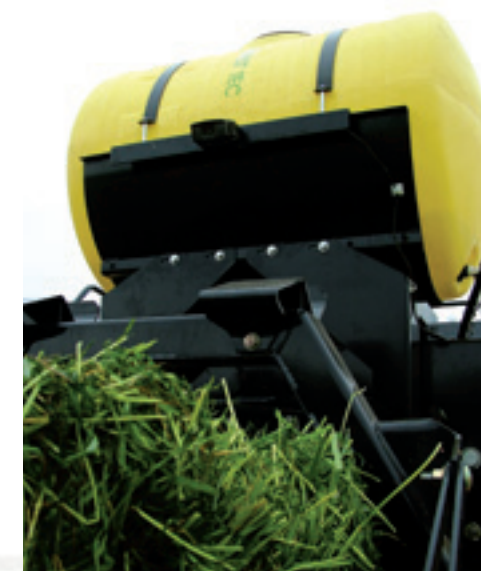
New Holland-dealers kunnen een 'inkuil' set monteren om zuur toe te voegen aan een baal hooi.
