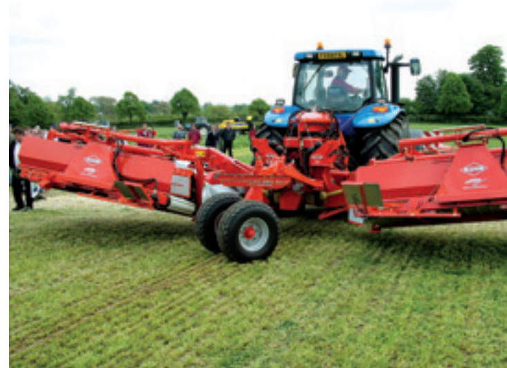
Een extra wielstel moet het gewicht van de triplemaaier van Kuhn beter verdelen.
