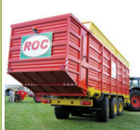
Nederlands fabrikaat, maar niet helemaal. De opraapwagen van ROC heeft 62 messen.
