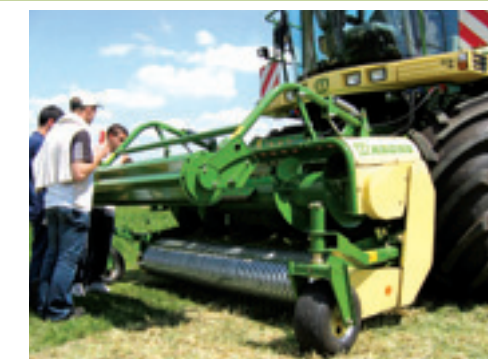
De nieuwe invoer/opraper op de Krone Big X hakselaar.
