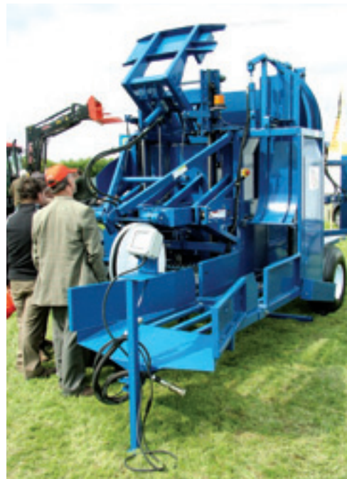
De Bale Band-It kan 21 kleine strobaaltjes verzamelen en vervolgens bij elkaar binden met metalen strips.
