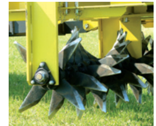
De messen zijn iets scheef op de as gelast zodat de grond meer wordt losgewrikt.
