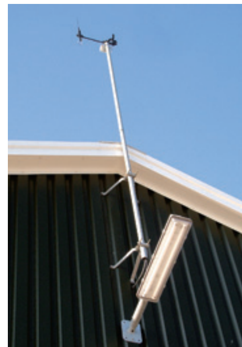
Een windsnelheids- en windrichtingsmeter en eventueel een regensensor maken deel uit van het weerstation op de kop van de stal.
