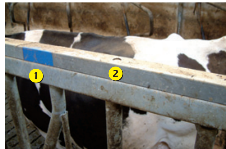
Onder het blauwe kapje (1) zit een elektromotor die een grendel opent en sluit. Daarnaast het knopje (2) waarmee de sluiting handmatig geopend kan worden.
