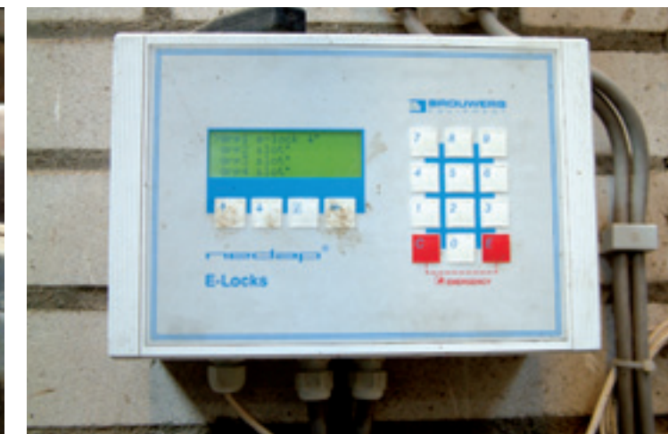
Via een knoppenkastje aan de muur is het E-Locks hek te programmeren.
