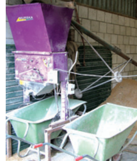
Een pletter voor droog graan heeft een capaciteit van zo'n 1.000 kilo per uur.
