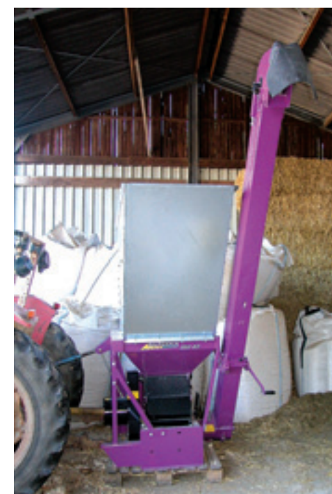
Dit is de veehoudersversie voor het pletten van nat graan. De capaciteit ligt rond 10 ton per uur en een trekker van 30 tot 65 kW (41 tot 88 pk) is voldoende voor de aandrijving.
