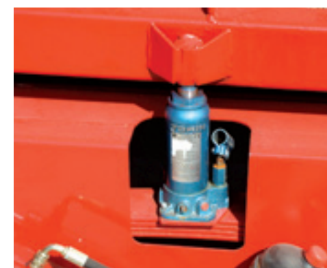
Via een krik op een bladveer wordt de druk op de pletrollen ingesteld.
