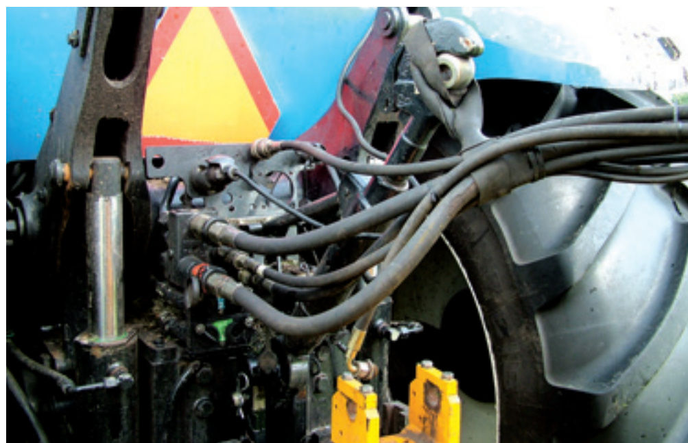
Van de nood een deugd maken: De hydraulische slangen worden met een rubberband gebundeld en opgehangen aan de 'overbodige' topstang.
