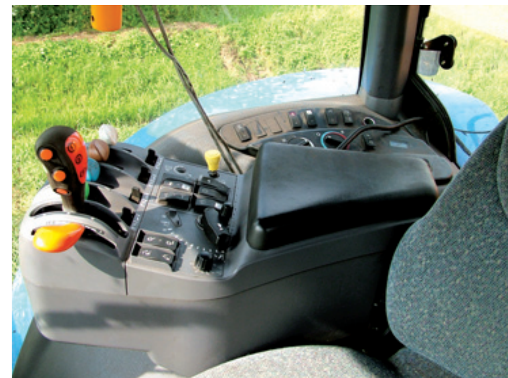
Met alle knoppen en hendels in de rechter armleuning is de trekker comfortabel te bedienen. De transmissie schakelt soepel, ook naar de andere groepen.
