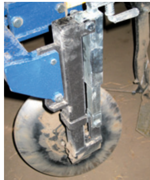
De in verstek staande holle schijven kunnen traploos in millimeter nauwkeurig versteld worden.
