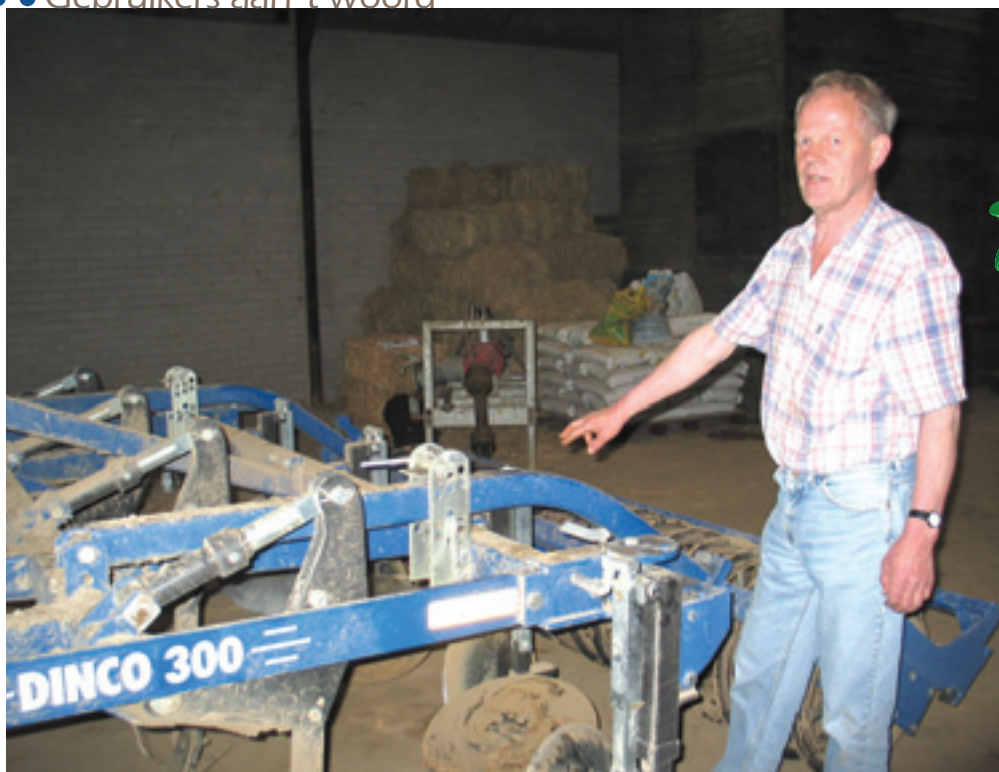
Jan Engelen geeft aan hoe de nalooprol door middel van de pen- / gatconstructie wordt ingesteld.
