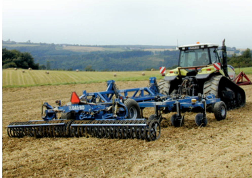
De halfgedragen Dinco Max heeft een werkbreedte van 6,0 meter.
