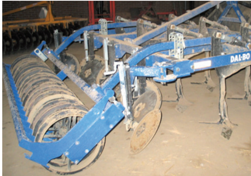
De Dinco 300 van Jan van Engelen is uitgevoerd met een grote 600 mm T-ring naloper.
