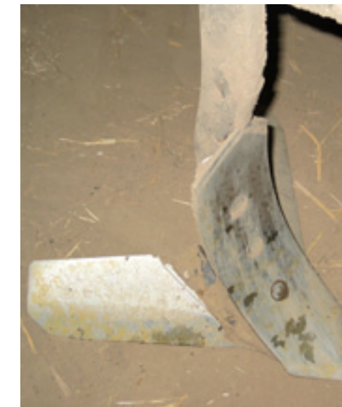
De vlakke vleugelschaar is goed geschikt voor extreem vlak werk.
