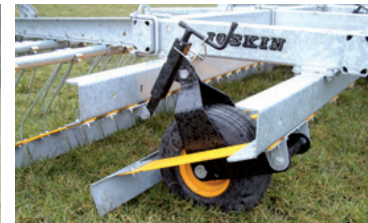
Via een luchtbandje en spindel is de hoogte in te stellen. Op de spindel zit geen schaalverdeling wat lastig is. Het wiel wordt als een van de zwakste schakels van de verder degelijke machine gezien.
