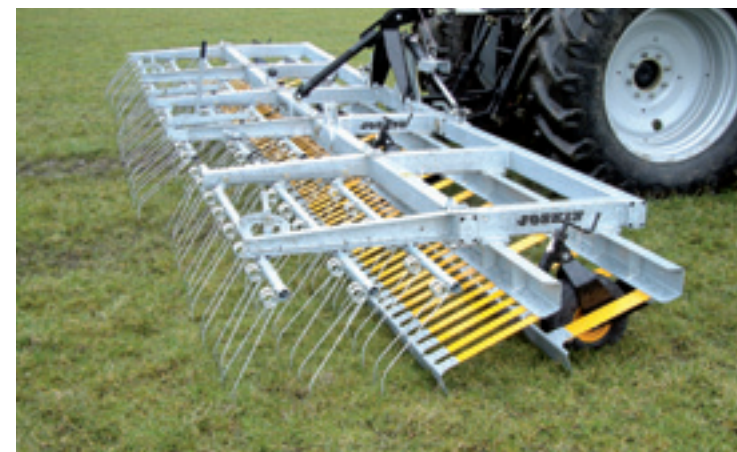
De eerste rij schrapers is 60 cm breed om hopen los te trekken. De tweede rij schrapers is 10 cm breed voor de verdeling. De drie rijen beluchtingstanden trekken oude grassen los.
