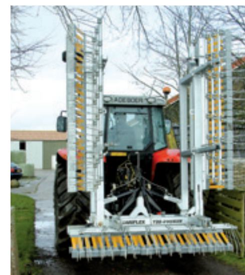
In transport is de Scariflex met een middenstuk van 2,40 meter niet te breed. Bij de sobere EBR4S-serie zijn er enkele modellen die in transport wel 3 meter breed zijn.
