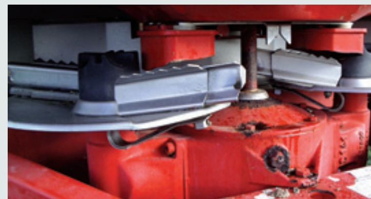
Gaten in de schoepen bij respectievelijk een Bogballe en een Rauch strooier (onder).
