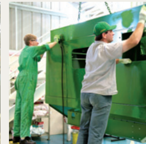
Werknemers van de fabriek controleren een graantank nadat hij door de splinternieuwe lakstraat is gegaan. De onderdelen waren elektrisch geladen zodat ze de verf aantrekken. Dat moet ook een goede bedekking geven in hoekjes waar je anders moeilijk bij kunt.
