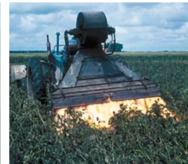
Het prototype: de enorme vuurzee was nodig om een zwaar loofbestand in één keer dood te krijgen.
