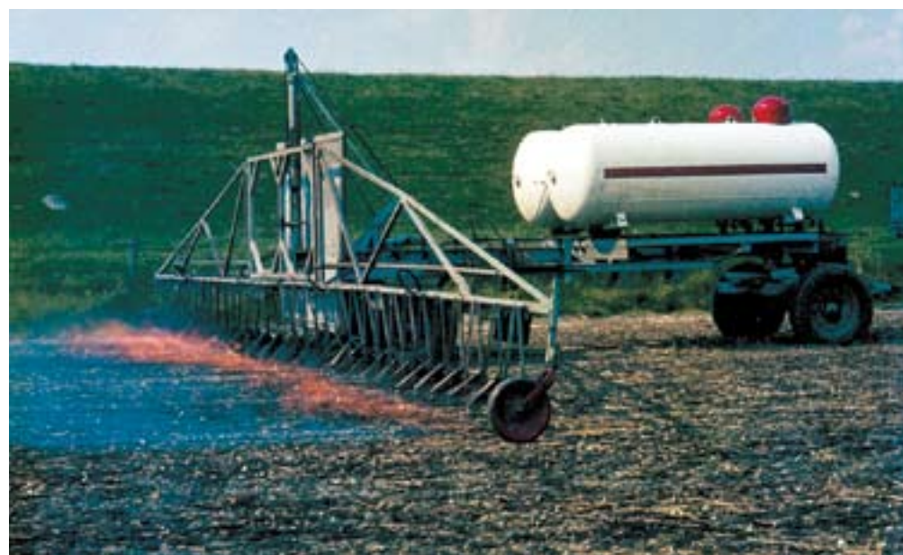
De Benegas-brander met een gasvoorraadtank en brede aanbouwboom met branders werkte goed op een veld zilveruien, maar was voor toepassing in aardappelen veel te duur.
