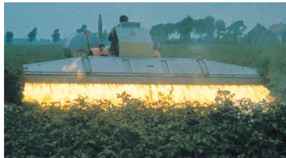
Met weinig wind bleven de vlammen wel onder de beschermkap. Bij veel wind mee kwamen de vlammen aan de voorzijde onder de beschermkap vandaan en sloegen onder de trekker door tot aan de open zitplaats op de trekker. Gevolg: Weggeschroeiende wenkbrauwen en verbrande bedrading van trekker en brander.
