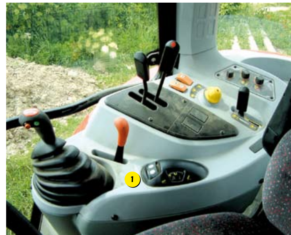
Op het overzichtelijke instrumentenpaneel is de draaiknop (1) voor de diepteregeling van de hefinrichting zwart en onverlicht. Dat geeft 's avonds laat soms problemen.
