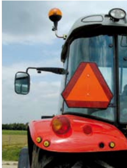
Alle veiligheid bij elkaar. Naast de verlichting en de retroreflector een afgeknotte driehoek, een zwaailicht en een grote spiegel. Met de knoppen kunnen zowel de hefstanden als de aftakas worden bediend.
