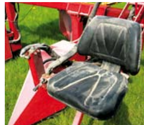
Wanneer je wilt stoppen, draai je de kogelkraan (boven) open. De olie wordt dan rondgepompt. Het stuurventiel dient om de hoogte van de zitplaats te verstellen.
