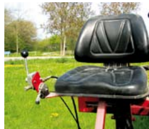
Met de hendel links op de foto bedien je de rijrichting, die daarnaast dient voor het handgas.
