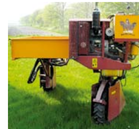
De krachtbron: een driecilinder dieselmotor van Kubota die een vermogen levert van 18 pk. Rechts de tank voor de hydrauliekolie, onderaan de dieseltank.
