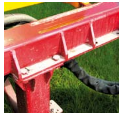
Wanneer je de selectiewagen op een spoorbreedte van 1,80 m wilt zetten, doe je dit door vier boutjes los te draaien en de wielophanging 30 cm naar buiten te verplaatsen.
