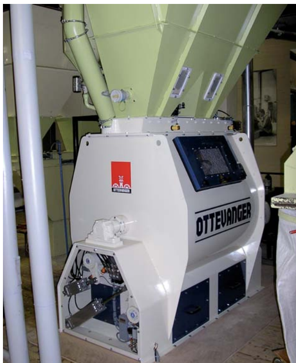
De mengmachine bij PTC+ is voorzien van plexiglas en verlichting zodat cursisten kunnen zien wat er in de machine gebeurt.
