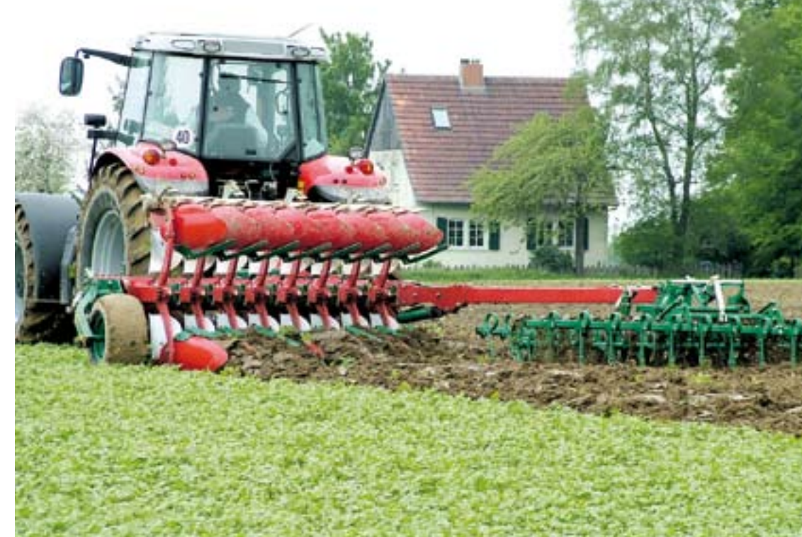
De Ecomat zien de meeste boeren nog als een ploeg, maar het is meer een snelle zaaibedbereider met een werksnelheid tot 12 km/h.
