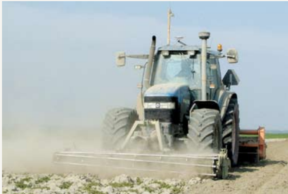
Op GPS recht rijden is niks anders dan rijden over een virtuele lijn die je ziet op het scherm in de trekker. Na het inlezen van het perceel en het invullen van de werkbreedte maakt de computer een aantal werkgangen. Je ziet dan meteen hoe je uitkomt...
