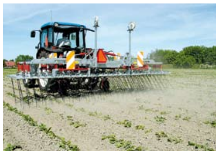
De aangedreven wiedege van Agro Techniek Holland beweegt ieder veld hydraulisch heen en weer. Dat moet het onkruid ook in de rij beter weg krijgen. Met groot onkruid valt het niet mee.
