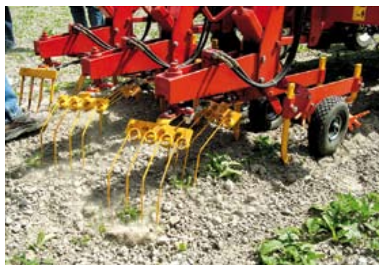
De Broekema Bio-Weeder. Armpjes met tanden bewegen in de rij en moeten zo het onkruid uit de rij tikken.
