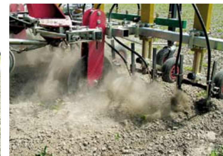
De Mutsaers QI schoffel heeft een spoorvolgend systeem, zodat je snel kunt rijden en toch nauwkeurig schoffelt. Door de machine uit te rusten met de Pneumat blaast hij het onkruid in de rij weg.
