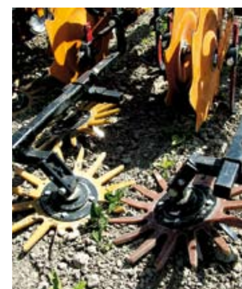
De machine van Schmotzer heeft vibrerende schoffels en vingerwiederers. Ze blijken te groot onkruid in bieten het best aan te pakken.
