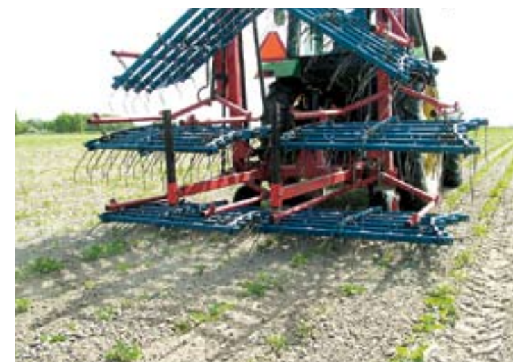
Een oude bekende. De Hatzenbichler wiedege pakt onkruid vooral in een vroeg stadium goed aan. Toch zijn de resultaten bij te groot onkruid niet slecht.
