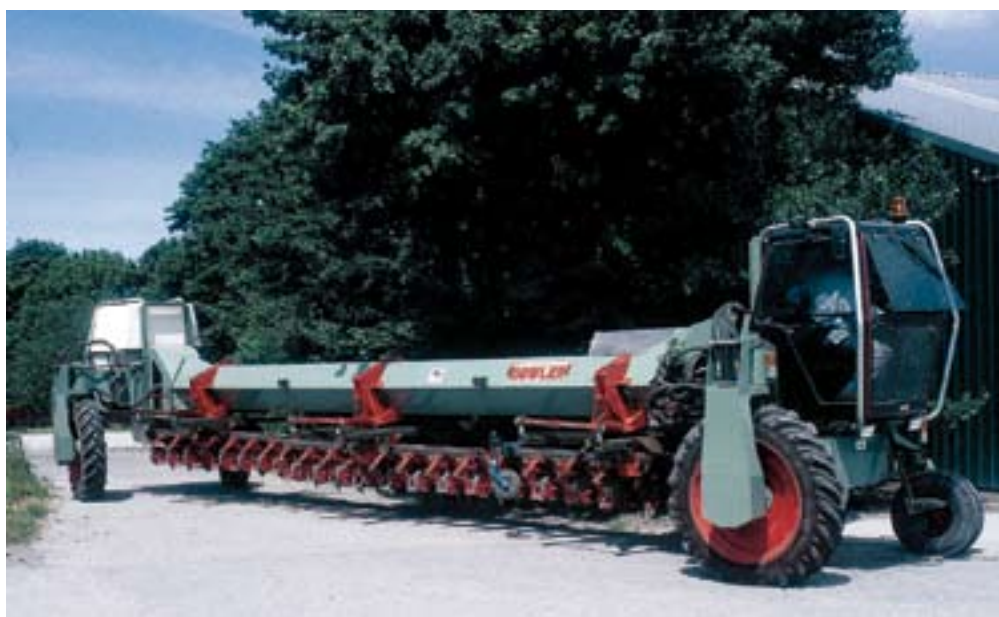
De grote werkbreedte was handig in het veld. Keren op de wendakker is een probleem. Voor het transport kunnen de wielen 90 graden gedraaid worden waardoor je een lange, smalle machine krijgt.
