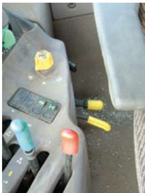
Rechts naast, min of meer verscholen onder de bestuurdersstoel, zitten twee hendels. De eerste voor de keuze van het aftakstoerental op 540 of 1000 omw./min en de tweede voor 'normaal' of 'eco-gebruik'.
