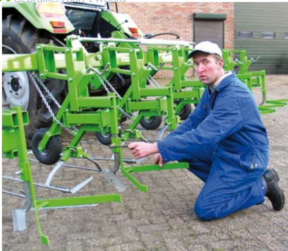
Hennie Henken stelt de anaarders af. Door deze in hoogte te variëren kan de intensiteit van het anaarden bepaald worden.
