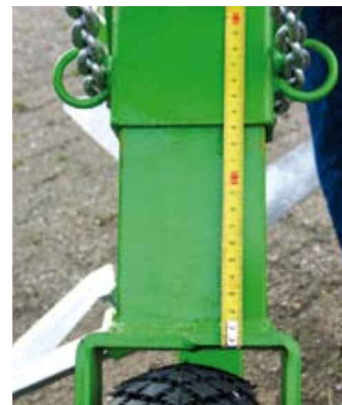
Het instellen van het steunwiel. Dit is van belang voor het juist afstellen van de werkdiepte
