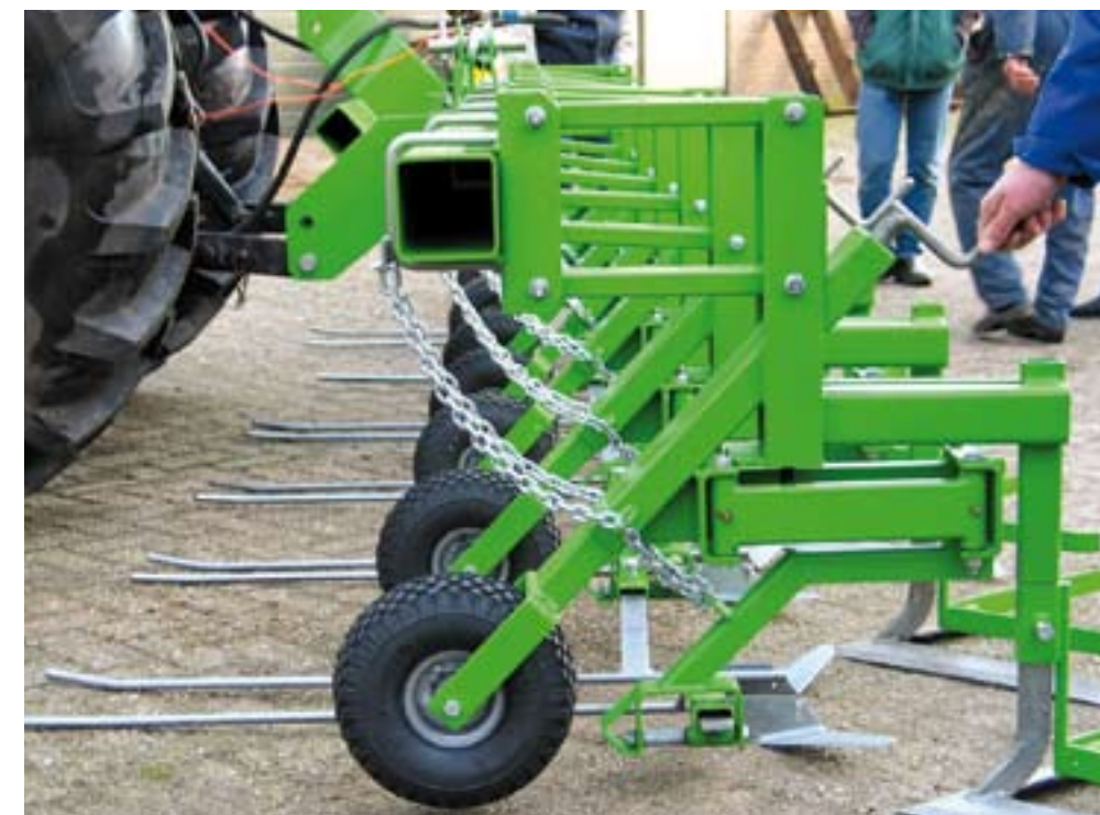
Het instellen van het steunwiel gebeurt met behulp van een draaispindel.
