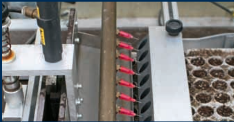
De naalden van een naaldenzaaier pakken door de onderdruk de zaden op uit een bakje. Op het juiste moment valt de onderdruk weg, waardoor het zaadje van de naald valt.
