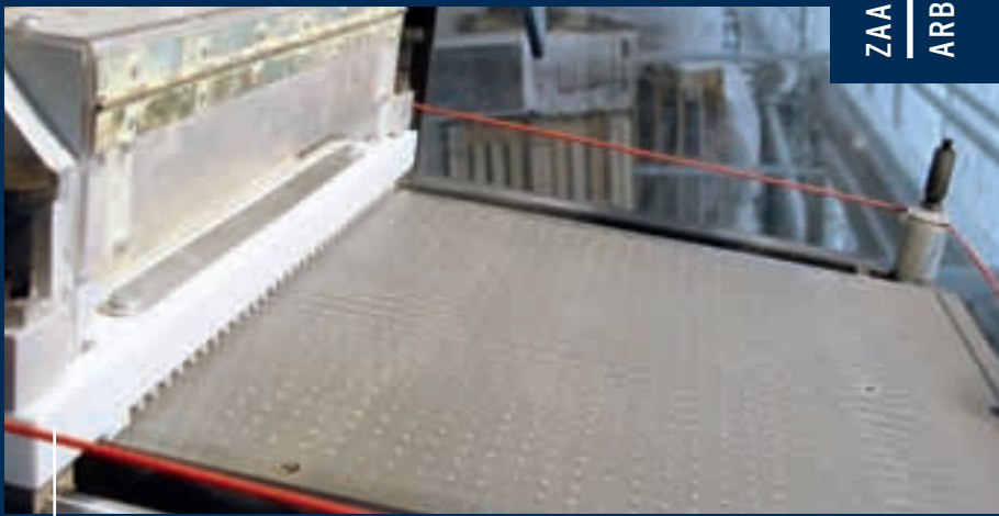
Een schuifzaaier werkt met een schuivende plaat. Als de plaat langs de zaadbak naar beneden schuift, vullen de gaten zich met zaad.
