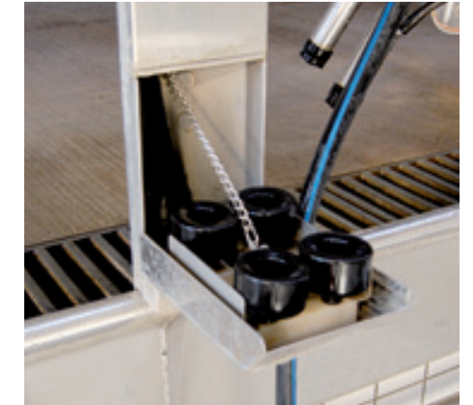
De jetterstellen klappen weg in de rvs-kolom en vormen zo geen obstakel meer.
