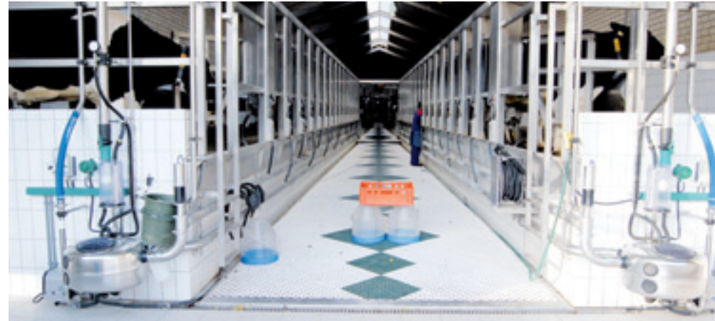
De hoogte van de putvloer is gelijk aan die van de rest van de stal. Je kunt dus makkelijk in- en uitlopen zonder trap.
