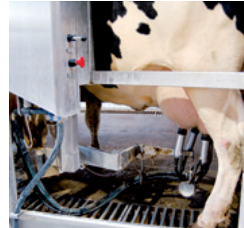
Door de melkarm kun je met twee handen tegelijk de bekers aansluiten. De klauwen voeren de melk aan de bovenkant af.
