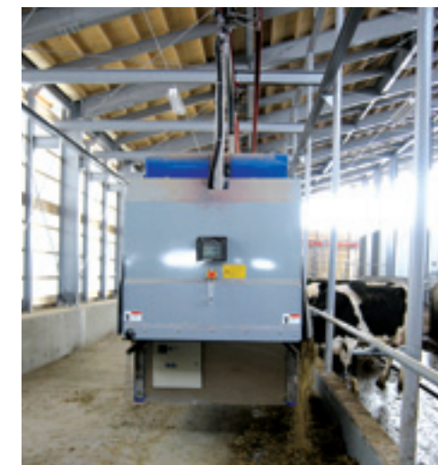
Net als deze Pellon zweven de voerrobots aan een rail door de stal. Door de geringe afmeting is een voergang van 2 tot maximaal 3 meter groot genoeg.
