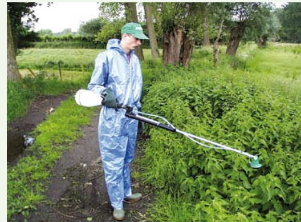
De onkruidlans van Agricult heeft een schijfvernevelaar om het geconcentreerde middel te verdelen.
