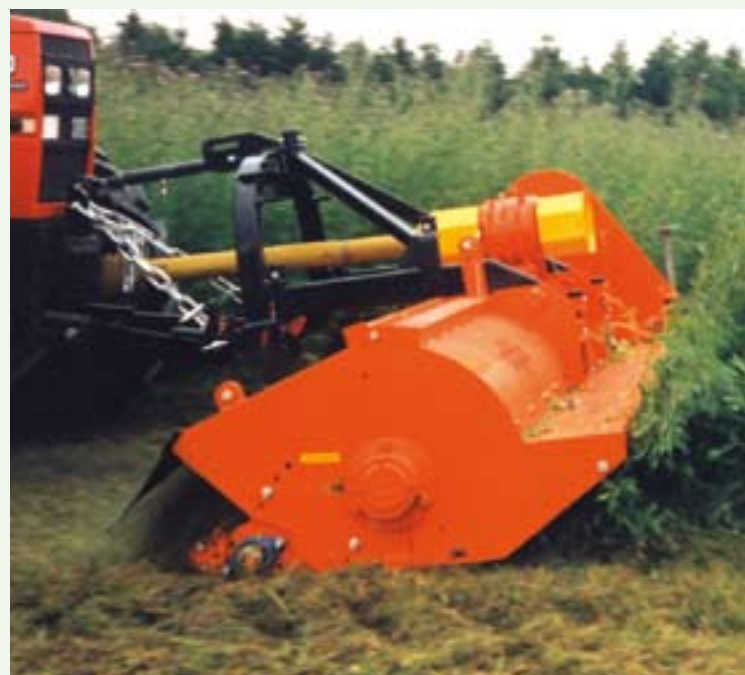
Als je een massale groenbemester voor de winter moet omploegen, is er een voorbewerking nodig. Met een frontklepelmaaier maak je het gewas goed klein en verspreid je het. Dit voorkomt een storende laag in de bouwvoor.
