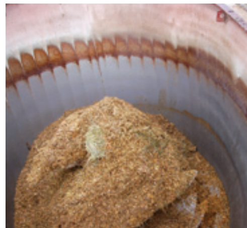
Aan de wand is het geribbelde profiel zichtbaar dat voor een betere mengwerking moet zorgen.
