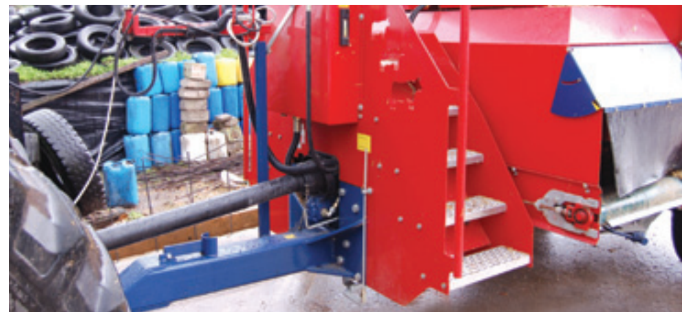
Voorop de wagen het eigen optionele hydraulieksysteem. Bij de aftakas de rvs-hendel voor de versnellingen. De rvs-stok naast de dissel geeft de hoogte van de steunpoot aan. Deze zit namelijk onder de wagen verstopt en er is dus geen zicht op.
