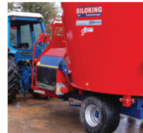
Achter de rvs-behuizing tussen hydro-motor en geleiderol van de transportband gaat de nokkenkoppeling schuil.
