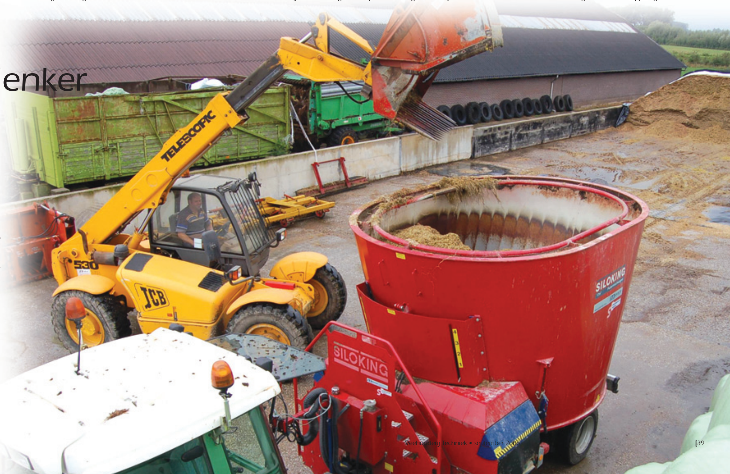
Aan de wand is het geribbelde profiel zichtbaar dat voor een betere mengwerking moet zorgen.
