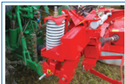
De dikke spiraalveer van de JF Stoll GX 3205 SM maaier zorgt voor de bodemaanpassing van de balk.
