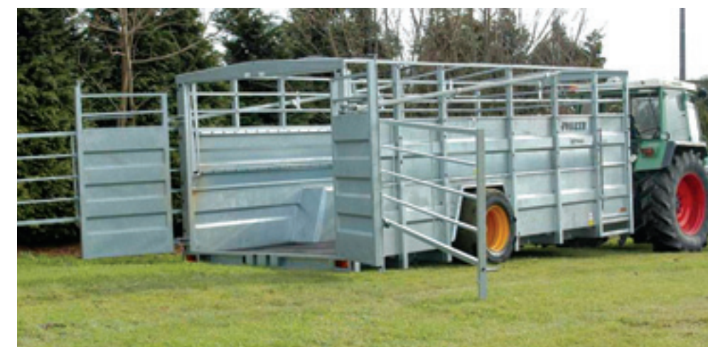
De Joskin met drijfhekken aan een geleiderails zodat ze recht achter de wagen schuiven. Daardoor hebben zij weinig ruimte nodig.
