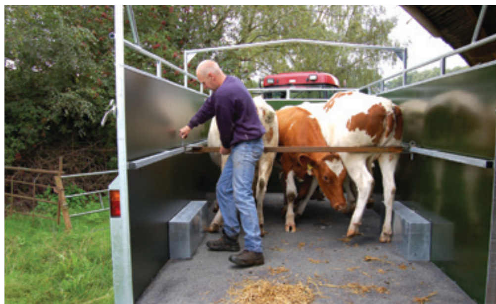
Koeien inklemmen met een beugel is veiliger voor de dieren en bij het dichtdoen van de klep. Deze wagen is verder uitgevoerd met een antislipvloer en een degelijk weggewerkte verlichting.
