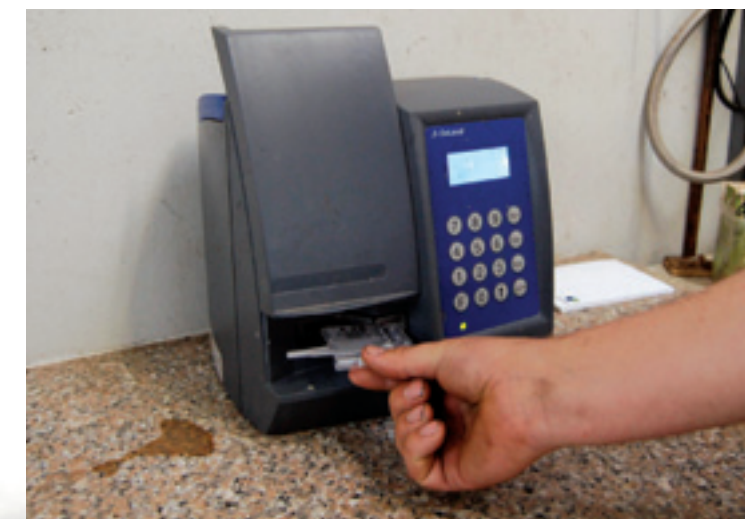
Na 45 seconden weet de DCC meter het celgetal van het monster. De cassette kan er maar op een manier in. Op het toetsenbord zitten diverse knoppen om gegevens mee in te voeren of om zelfs de display-kleur bij te stellen.
