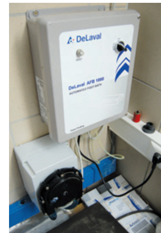
De bedieningskast van de DeLaval AFB1000. In de kast zit een microprocessor die je zelf kunt programmeren. Onder de kast de pomp die het klauwverzorgingsmiddel opzuigt.
