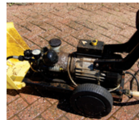
Een hoogtoerige motor veroorzaakt een fijnere en schadelijkere trilling dan een laagtoerige motor.
