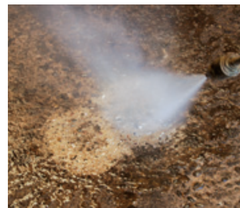
Een roterende nozzle is tien keer krachtiger en reinigt een groter oppervlak dan een vlak- of puntstraal.
