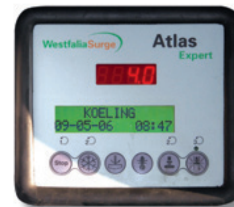
Een gemiddelde besturingskast geeft duidelijk de activiteit, datum en tijd weer en heeft slechts een paar knoppen voor de belangrijkste functies.
