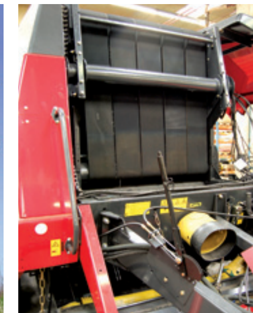
Riemen zijn minder geschikt voor persen in silage en meer voor persen in stro. Door extra aandrijfrollen en drukregeling zodat de kern niet te hard wordt, blijken ze toch bruikbaar.
