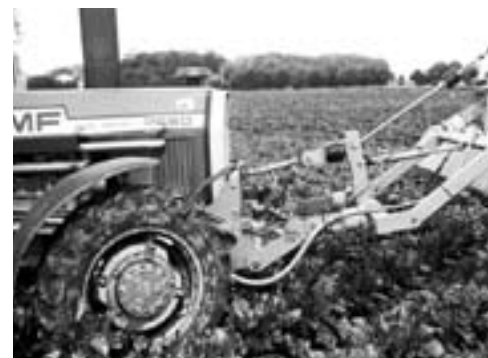
De fronthead van de MF 2680 is uitgerust met zware isolatoren en scheidt zo het machinedeel dat onder hoge spanning staat, van het geaarde deel.
