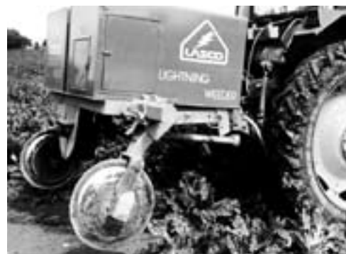
Met de twee zware schijven die tijdens het werk door de grond liepen, werden de Lasco-generator en de trekker geaard.
