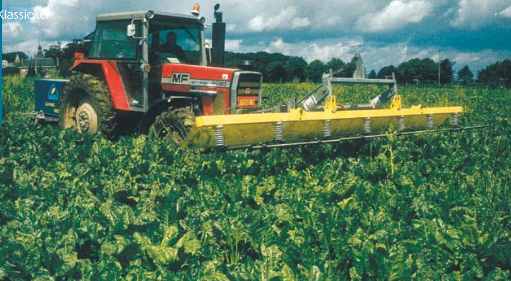
De Lasco 'lightning weeder' in bedrijf. Als er veel schieters en onkruid in het gewas stonden, werd veel stroom afgenomen. Zoveel zelfs dat de motor van de MF 2680 met 92 kW aftakasvermogen werd gesmoord.
