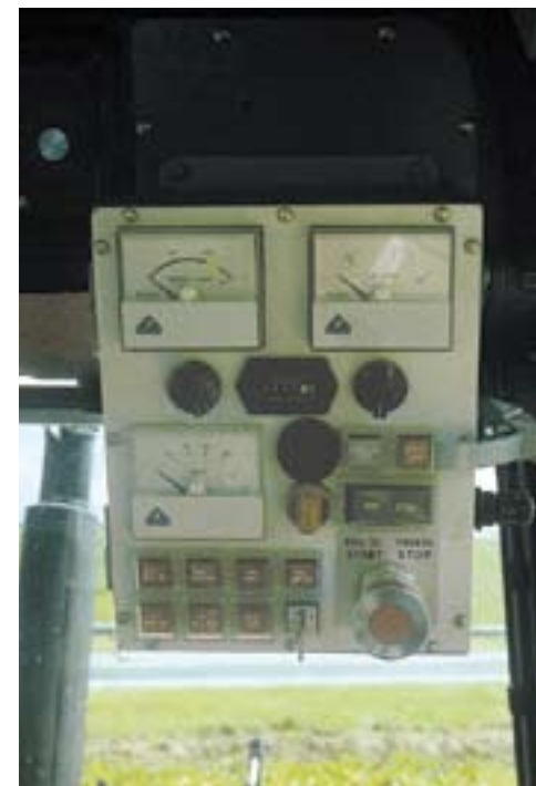
De controle- en regelbox in de trekkercabine onder handbereik van de zittende trekkerbestuurder. De dodemansknop onder de zitting van de stoel moest permanent ingedrukt blijven. Bij opstaan werd de brandstoftoevoer onmiddellijk afgesloten en viel de trekker – en daarmee de generator – stil.
