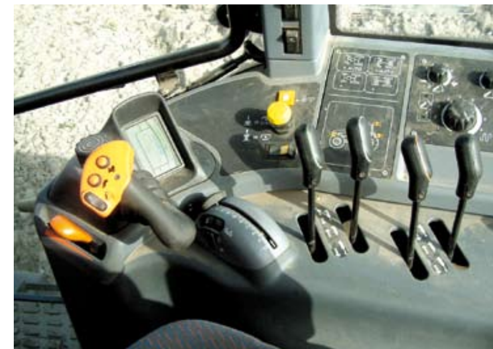
Bedieningsconsole met scherm waarin je kunt zien in welke versnelling de trekker rijdt.
